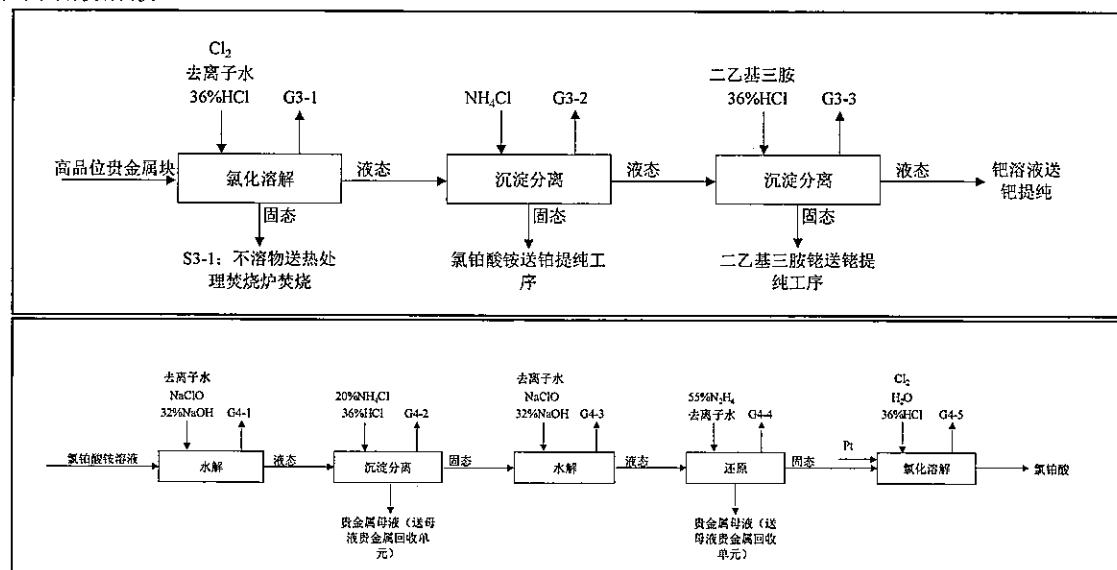
3.3 钯的精炼生产：氯铂酸滤液进入反应釜，在氯酸钠和盐酸的作用下，从 2 价氧化成 4 价，再和氯化铵反应生成氯钯酸铵（红色的盐）沉淀。溶液冷却后过滤，滤液送母液贵金属回收单元，红色的盐转移到下一步溶解工序；氯钯酸铵沉淀中加入去离子水，形成氯化钯。加热至沸腾，促进红色的盐溶解。再加入氨水及氢氧化钠溶液，反应生成二氯四氨钯溶液；二氯四氨钯中加入盐酸生成二氯二氨
