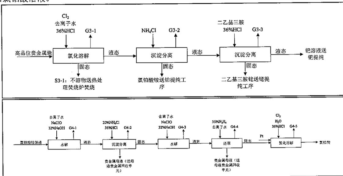
3.3 钯的精炼生产：氯钯酸滤液进入反应釜，在氯酸钠和盐酸的作用下，从 2 价氧化成 4 价，再和氯化铵反应生成氯钯酸铵（红色的盐）沉淀。溶液冷却后过滤，滤液送母液贵金属回收单元，红色的盐转移到下一步溶解工序；氯钯酸铵沉淀中加入去离子水，形成氯化钯。加热至沸腾，促进红色的盐溶解。再加入氨水及氢氧化钠溶液，反应生成二氯四氨钯溶液；二氯四氨钯中加入盐酸生成二氯二氨
